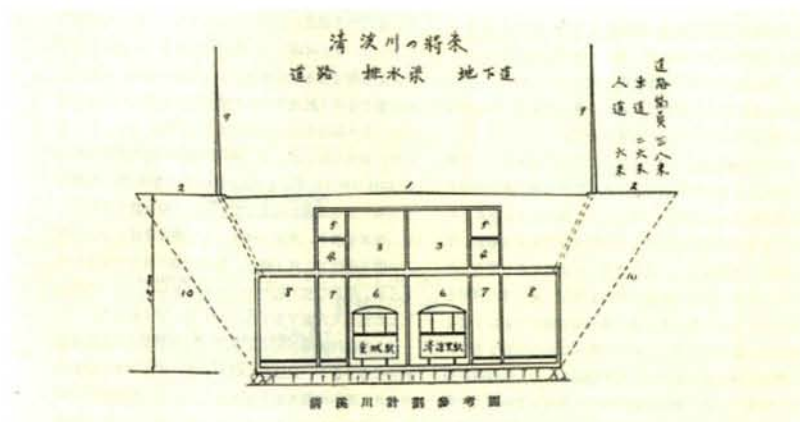
1. 차도, 2. 인도, 3. 배수구(높이 3m, 폭 8m), 4. 하수구(높이 1.5m, 폭 2m), 5. 수도, 가스, 전선통(높이 15m, 폭 2m), 6. 지하철(높이 6m, 폭 8m), 7. 소매가로(높이 6m, 폭 6m), 8. 소매가로(높이 6m, 폭 6m), 9. 전주 검 배기통, 10. 절취선(깊이 12m) (그림50) 청계천의 계획참고도
